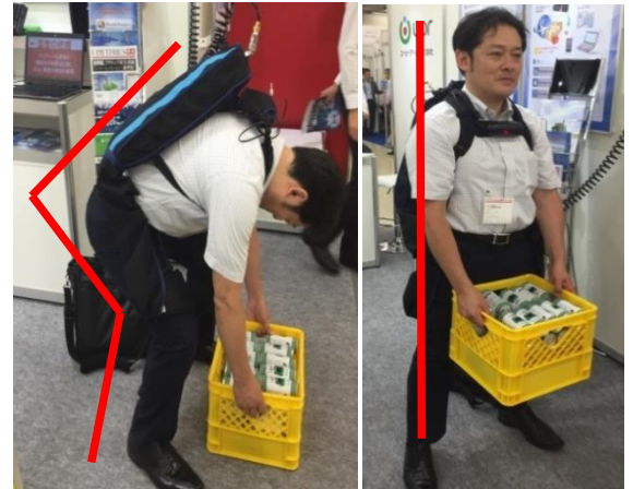
写真左：スーツを着用し腰を曲げて保持 写真右：スーツが稼働し荷物が持ち上がった状態
